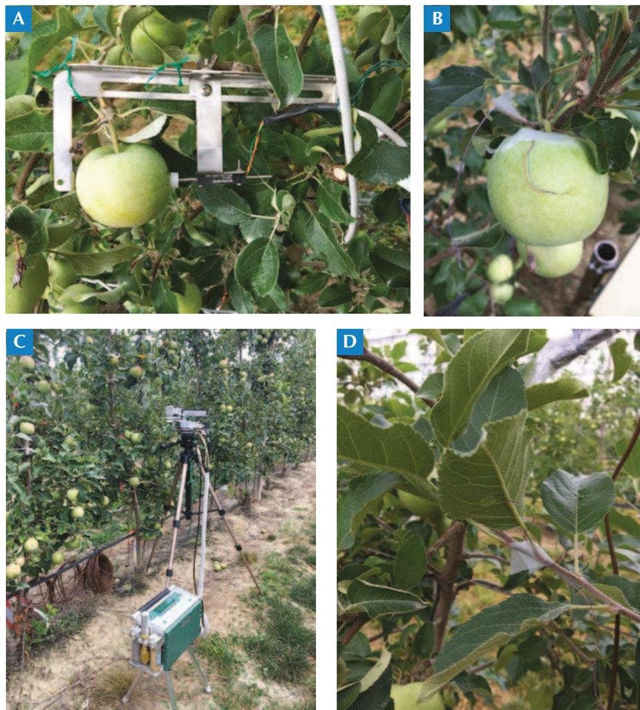
▲ Fig. 3 - Particolare delle termocoppie poste su frutto (A), su foglia (B), dello strumento di misura degli scambi gassosi (C) e del sensore di misura precisa di crescita del frutto (D).
