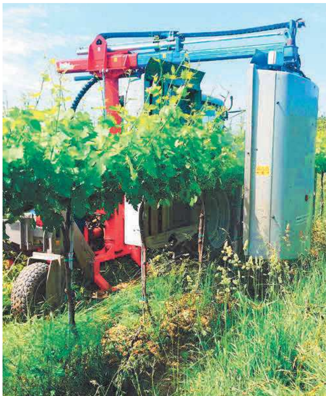
Foto 3 Irroratrice a recupero di prodotto operativa su vigneto di Sangiovese a cordone libero
