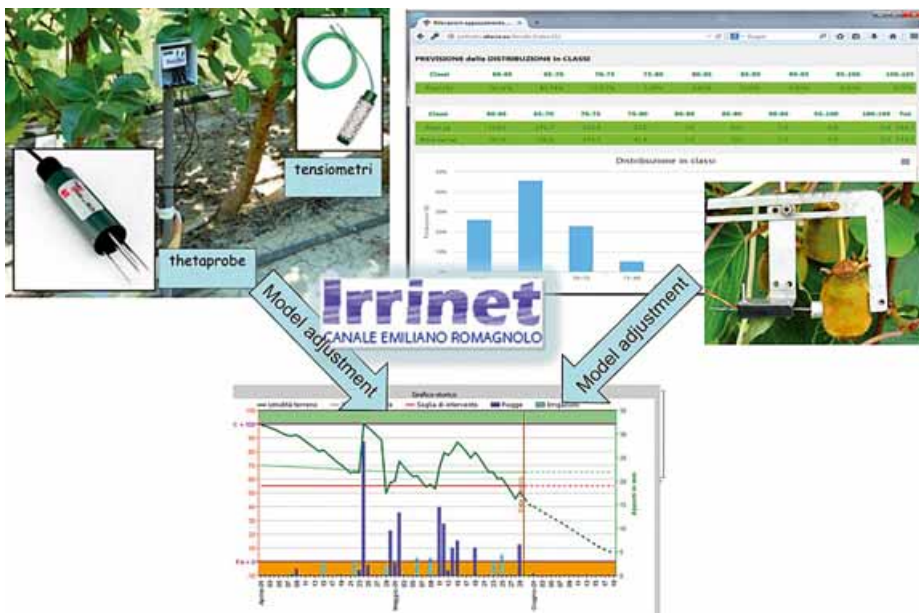
FIGURA 1 - Schema del sistema Irriframe integrato con sensori e Irrinet
