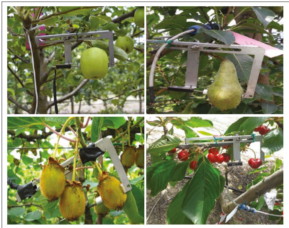
▲ Fig. 2 - "Fruttometro"; sensore per la misura accurata e continua della variazione diametrale dei frutti, montato su differenti specie di fruttiferi.
