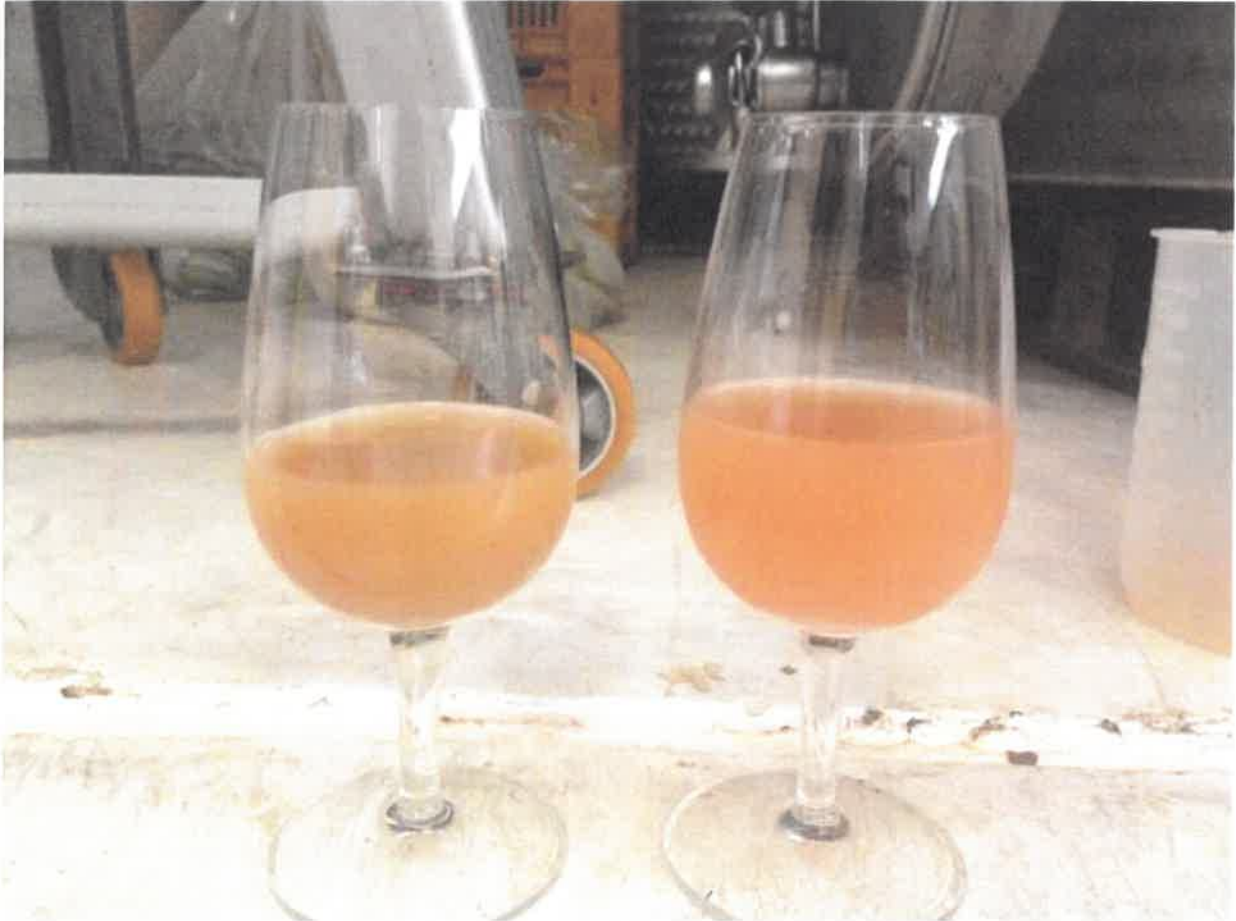
FIGURA 1_Mosto acido dopo 36h a 4°C a seguito aggiunta coadiuvanti di chiarifica (a sx fondo contenitore, a dx parte alta contenitore)
