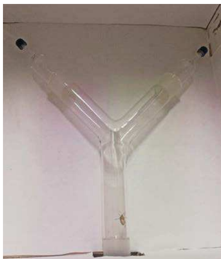
Foto 1 Olfattometro a 2 vie detto a Y utilizzato nelle prove per valutare la repellenza esercitata dagli estratti sugli insetti target (nella foto Halyomorpha halys )
